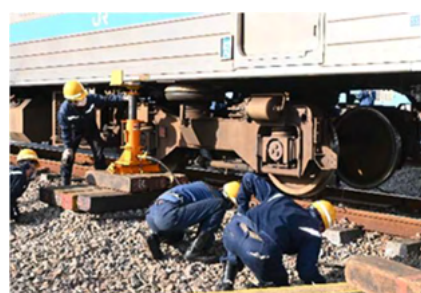
【油圧ジャッキでの載線作業】
