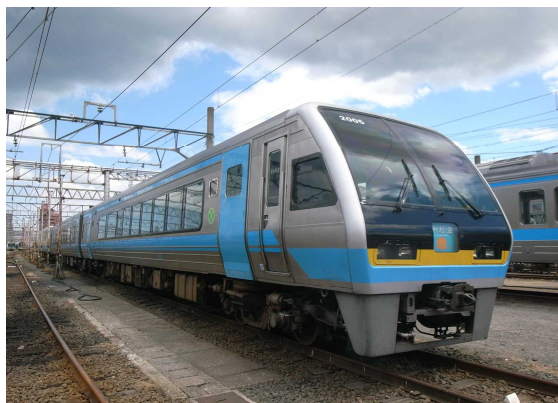
▲JR四国 2000系特急気動車 （制御式自然振子車両）
