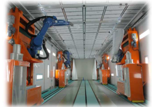
【工場の塗装ロボット（イメージ）】
