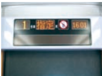
車内出入口上の車號・ 座席種類の標識
